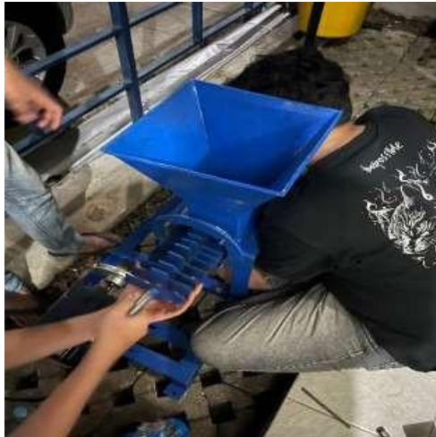
Gambar 1. Mesin tipe chopper yang dipasang pisau pencacah
