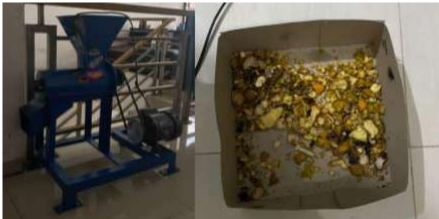
Gambar 2. Mesin Pencacah dan Hasil Uji Mesin Pencacah
